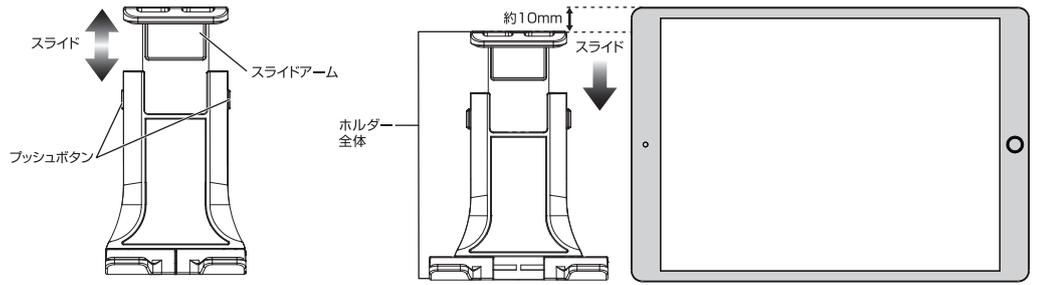
③タブレットでパネ式スライドアームを押し上げ、ホルダー本体に設置してください。
