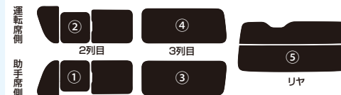
5ドア 2列目窓ガラス両側スライド式 3列目窓ガラス両側固定式 リヤワイパーなし
